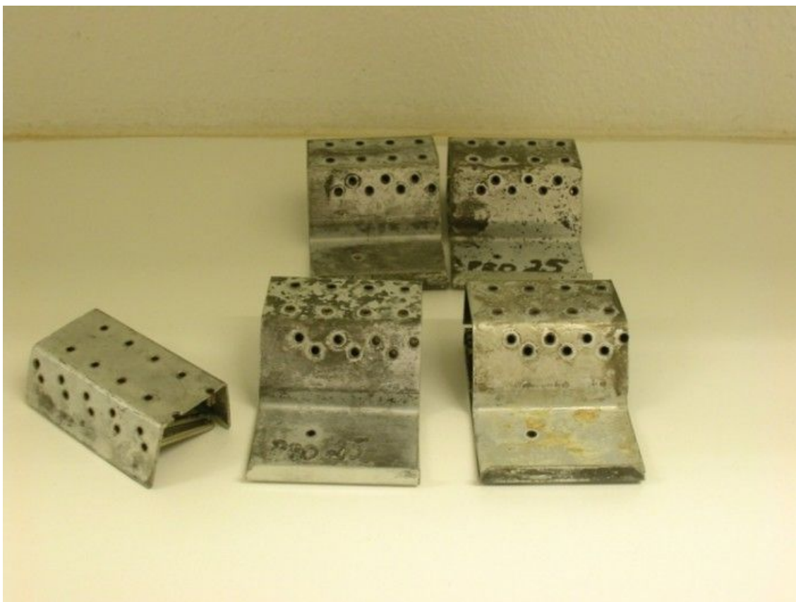
Abb. 3: Korrosion ist ein häufiges Problem, wenn unterschiedliche Materialien in ein und derselben Flüssigkeit behandelt werden - dies ist bei Aluminium und nicht rostendem Stahl der Fall.
