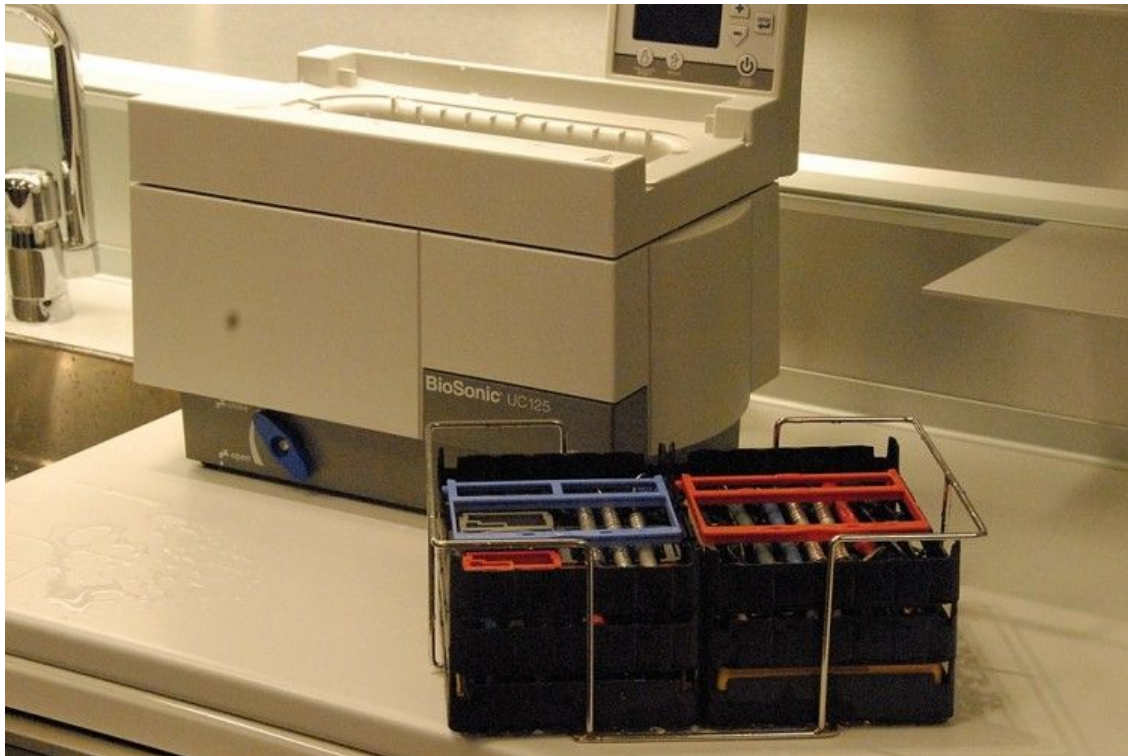
Abb. 2: Im Fall der Ultraschallreinigung werden Instrumente am besten gereinigt, wenn die Instrumente befestigt, aber frei zugänglich sind und die Befestigungsvorrichtung nicht berühren.
